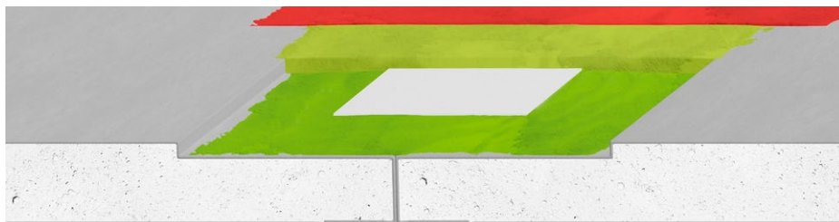
Rys. 5. Spoinowanie krawędzi typu PRO z użyciem taśmy fizeleinowej lub taśmy papierowej
