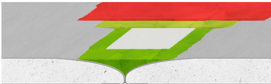
Rys. 7. Spoinowanie krawędzi KPOS z taśmą papierową lub z włókna szklanego wtopioną w masę szpachlową
